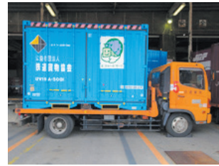
防振コンテナ外観
