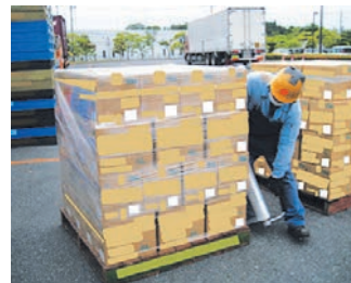
写真5 ストレッチフィルムの養生作業
