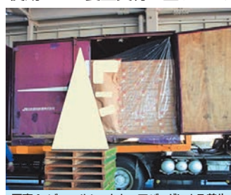
写真4 ビニールシートとエアバッグによる養生
