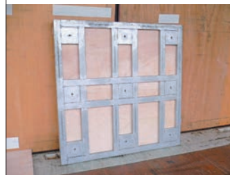
写真2 フレーム防振資材積載面
