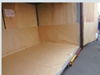
写真4 コンテナ養生
