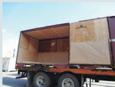
写真1 紙袋積み込み前状況コンテナ内側 (扉を含む)高さ1mにクラフト紙を貼付
