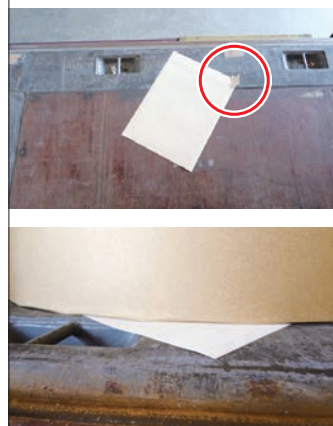
写真1 防滑紙をコンテナの床面に敷いた写真
