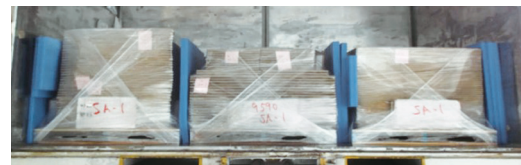
写真1 ブルーボードの組み合わせによる養生
