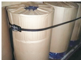
写真2 ベルト荷締機で締めた状況
