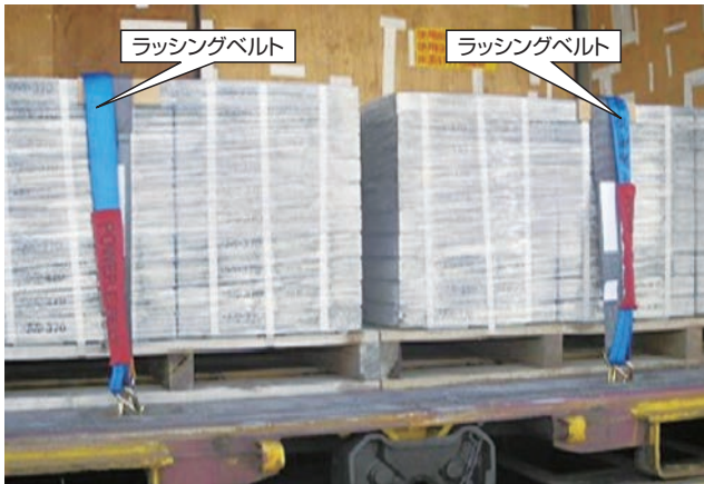
図1 コンクリート製品の養生例(改善後)
