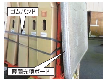
図6 養生後の荷姿②
