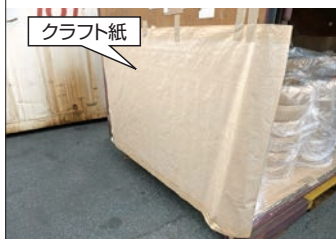
図5 電線の養生例(扉部①)
