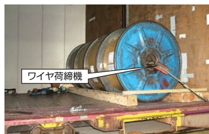
図9 鉄ボビンの養生例(対策後)
