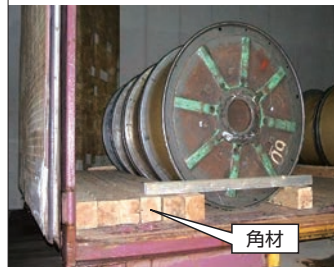
図7 鉄ボビンの養生例(対策前)
