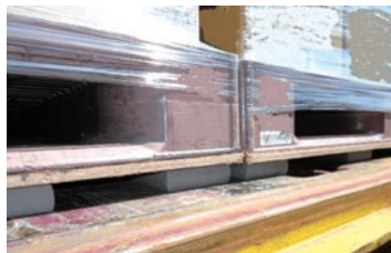
【写真3】 （左）5.0t設計 （右）3.5t設計 防振資材
