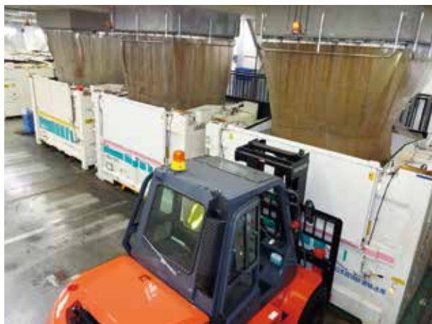
2階の収集車から1階に設置された「プラスチック製包装容器専用コンテナ」への積み替え作業
