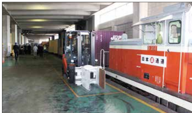
専用の入換動力車とクランプフォークリフト
