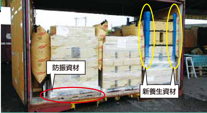
発駅での養生状況
